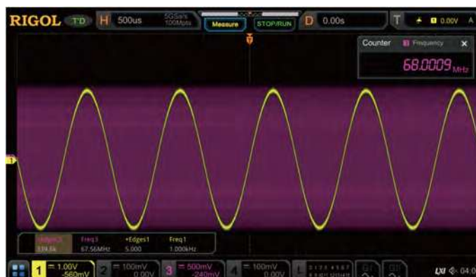
Наблюдение и точное измерение двух сигналов с большим различием частоты. Измерение с использованием всей памяти позволяет измерить точное значение частоты сигнала и длительность фронта 339.6к.
