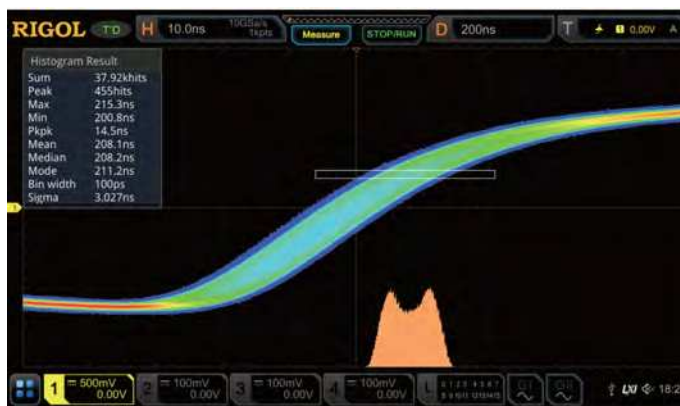
Горизонтальная гистограмма формы сигнала
